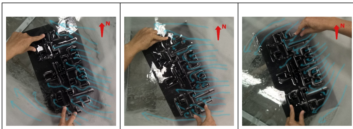
Figura 5 – Simulações em mesa d'água para o estudo de caso 4: vento Sudeste, Leste e Nordeste, respectivamente
