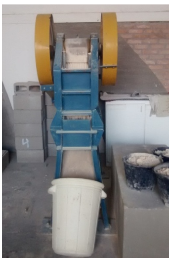
Figura 3 – Equipamentos e RSPC: (a) Britador de mandíbulas; (b) Moinho de bolas horizontal; (c) aspecto do RSPC após a moagem
