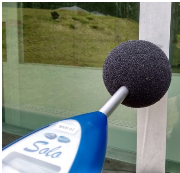
Figura 3 – Medidor de nível sonoro posicionado em frente a uma das fachadas estudadas sustentado pelo operador com espuma protetora.
