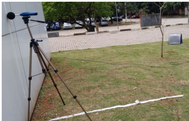
Figura 2 – Medidor de nível sonoro posicionado em frente a uma das fachadas estudadas sustentado por um tripé.
