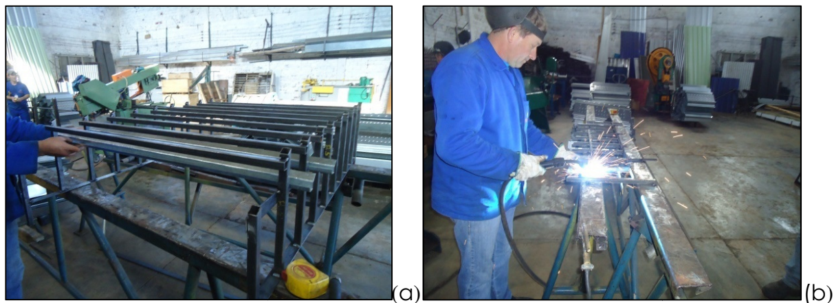
Figura 2 – Procedimentos de solda (a) e de montagem (b) dos modelos
