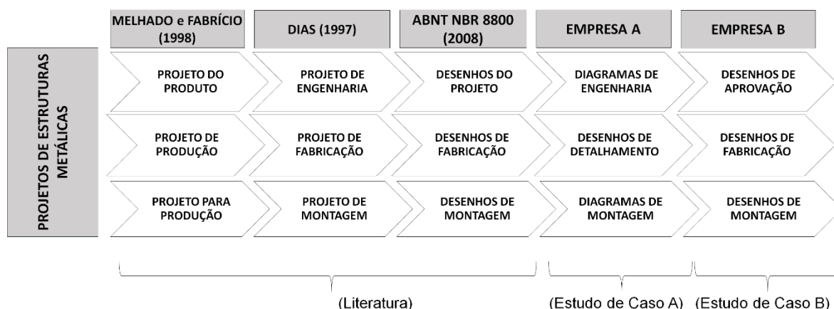
Figura 5 – Etapas dos projetos de estruturas em aço das empresas avaliadas em comparação com aquelas identificadas na literatura
