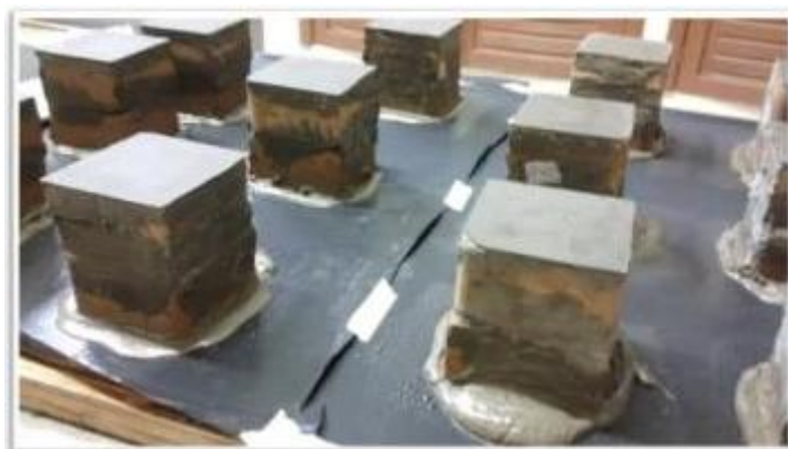
Figura 4 – Imagem do capeamento das amostras.
