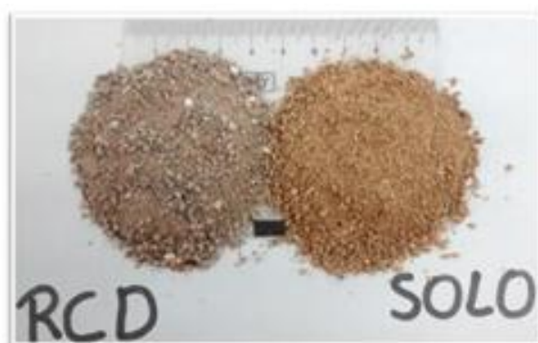
Figura 2 – Imagem dos Materiais utilizados: Resíduo de Construção e Demolição (RCD) e Solo.
