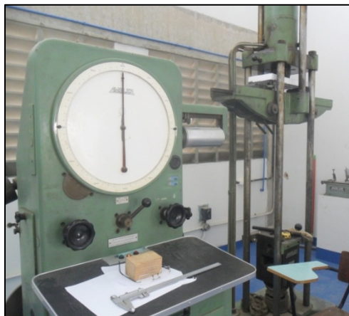
Figura 8- Máquina universal de ensaios (tração, compressão e flexão)
