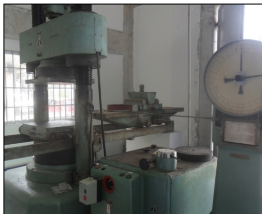
Figura 6- Bases de compressão e o relógio de medição de força da maquina de compressão
