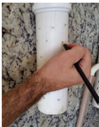
Figura 9 - Confeção do abrigo vertical (a) marcando os pontos; (b) furando; (c) peça semi-pronta; (d) inserindo fundo no tudo
