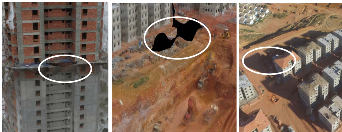
Figura 6 – Exemplo de inconsistências visuais nos modelos 3D: (a) Distorções; (b) Falhas (buracos); (c) Sombreamentos.
