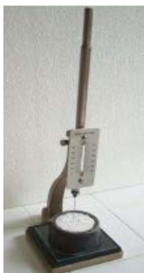
Figura 02: Realização do ensaio de tempo de pega com o aparelho de Vicat
