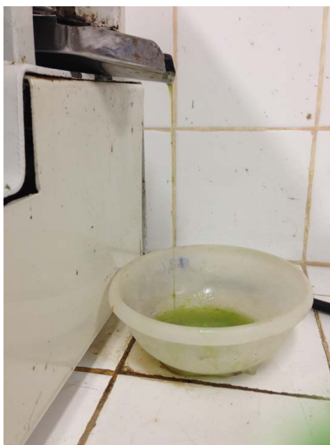
Figura 01: Mucilagem da Opuntia Ficus Indica retirada com a prensa
