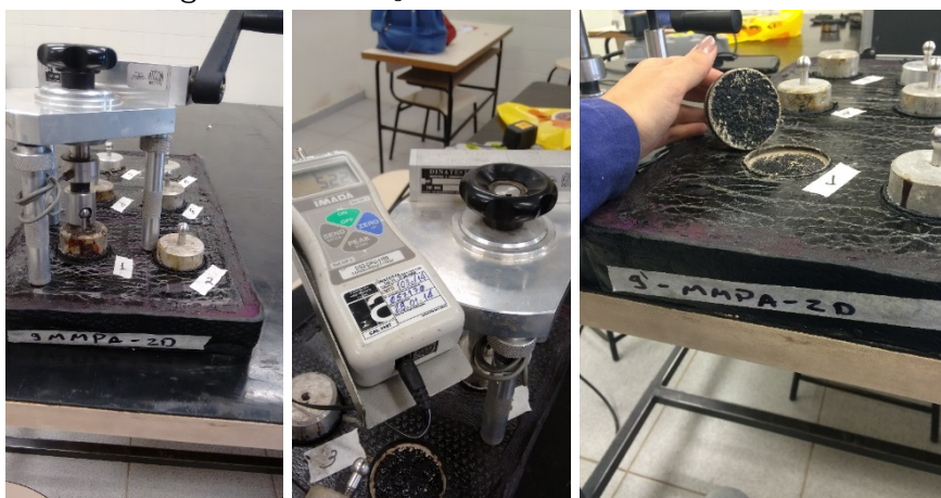
Figura 8: Execução de teste de aderência
