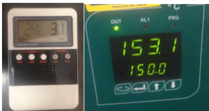
Figura 1 – Detalhe do painel de controle da estufa e do controle de temperatura e umidade relativa do ar
