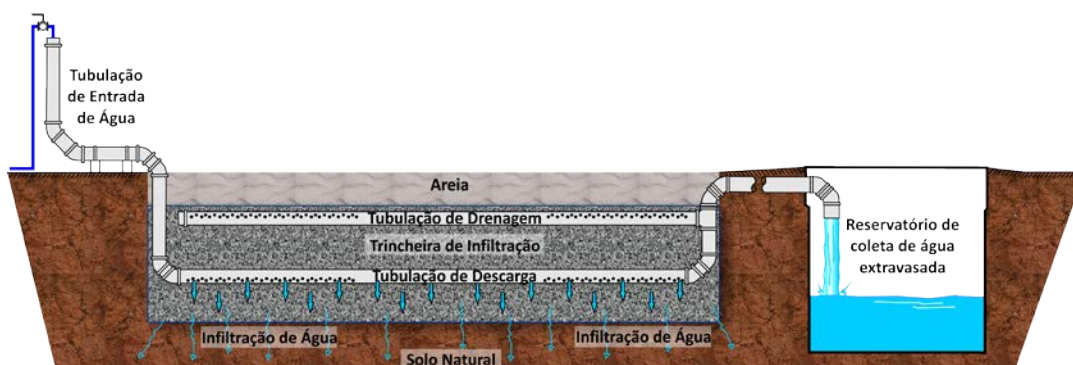
Figura 3 – Detalhe esquemático da trincheira de infiltração experimental.
