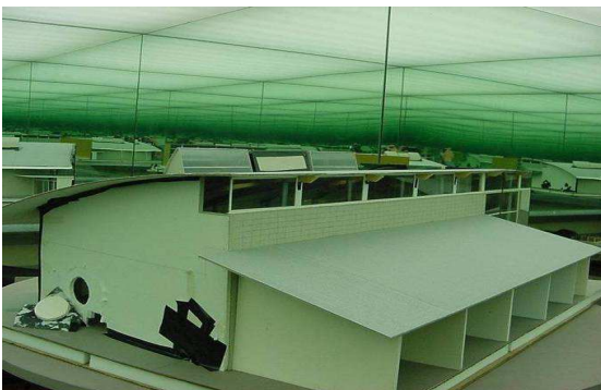
Figura 3. Laboratorio de Estudios Bioambientales del CIHE. a. Heliódón de múltiples soles: Ensayos en estudios de Evaluación de Impacto Ambiental. Proyecto de desarrollo urbano, Buenos Aires.
