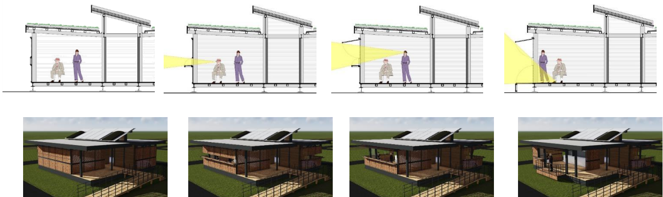
Figura 7, Configuraciones del cerramiento de Casa Alero
