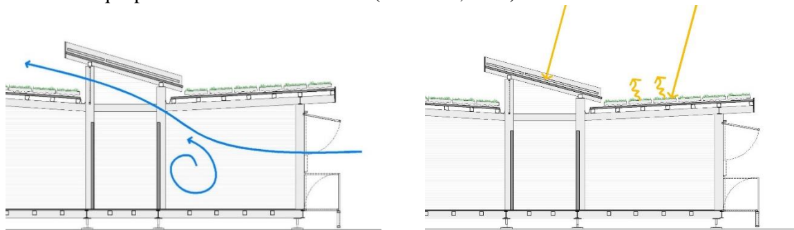
Figura 5, Estrategias bioclimáticas pasivas de la Casa Alero
