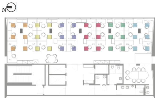
Figura 3 - Planta de forro com luminárias, com diferenciação, por cores, das seções de acionamento.
