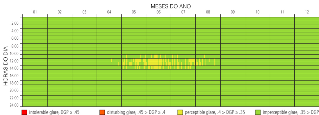
Figura 24: Annual Glare para a Câmera 02, modelo MC1.
