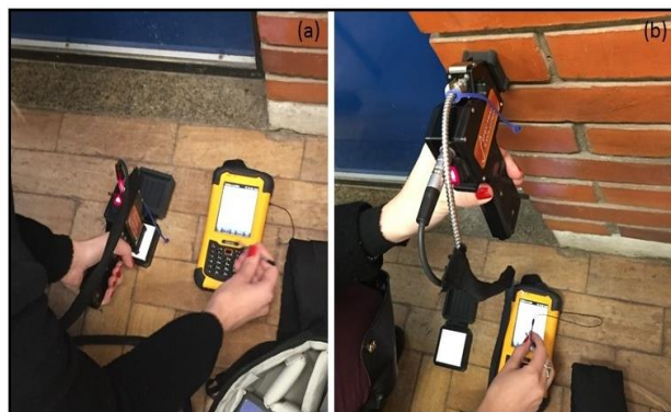
Figura 3. Medição in loco : (a) placa Spectralon ; (b) superfície alvo (autores)
