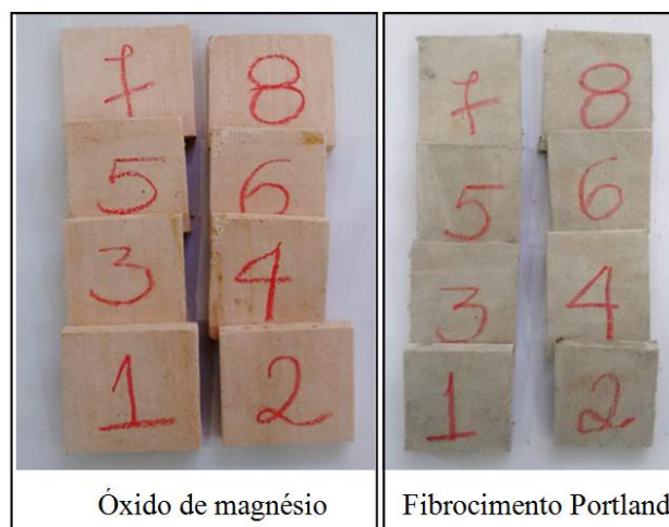
Figura 5 – Corpos de prova utilizados para realização da caracterização das placas analisadas.
