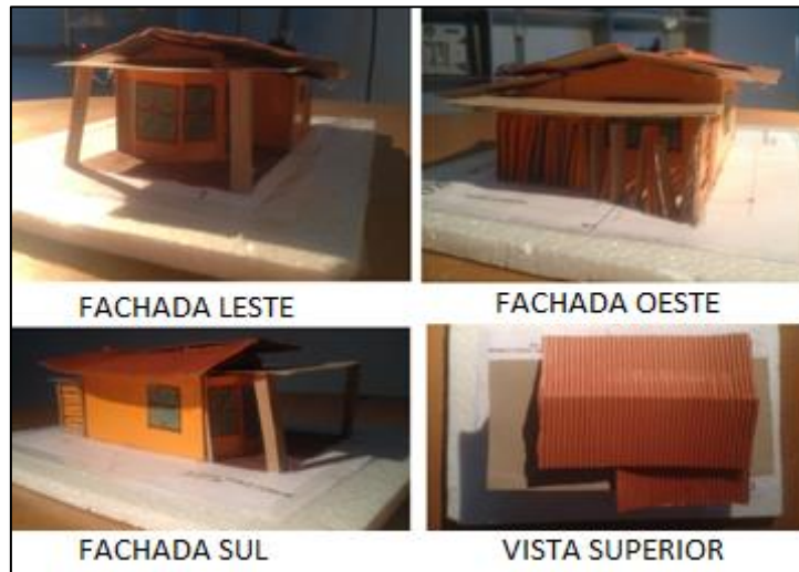
Figura 15: Ensaio no heliodon da maquete do chalé standard às 15h durante o solstício de verão.
