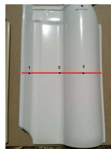
Figura 3 - Representação da linha imaginária utilizada para medida da temperatura superficial.
