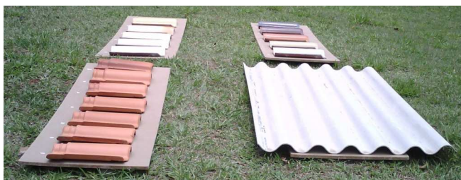
Figura 2 - Telhas expostas à radiação solar para medições de temperaturas superficiais.
