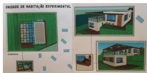
Figura 3 – Exemplos de projetos arquitetônicos de edificações com uso excessivo de superfícies transparentes à radiação solar, como proposta para um terreno situado na cidade de Salvador-BA.
