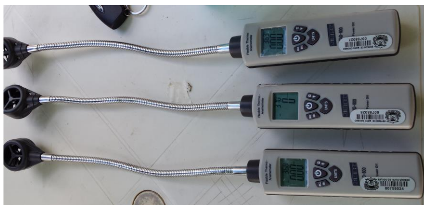
Figura 6 – Termo Anemômetro Digital Portátil TAD-800 da marca INSTRUTERM utilizado para as medições.
