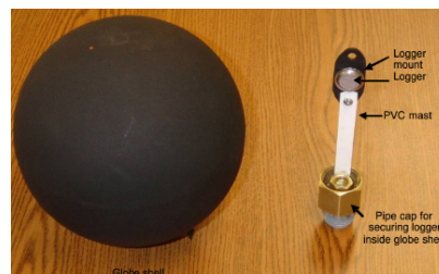
Figura 2 – Globo de cobre de 0.15m de diâmetro (esfera de bomba de água) e base de fixação para registrador de temperatura do ar tipo “botão” (PURSWELL e DAVIS, 2008).
