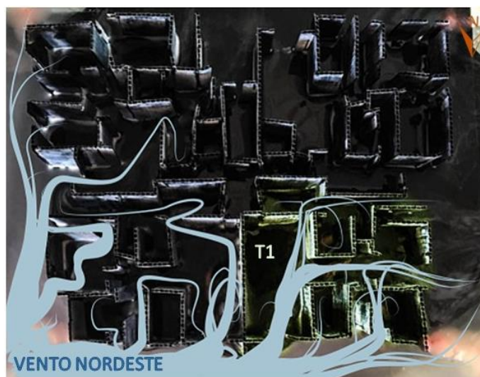
Figura 04 – a) Planta Baixa da Terminação 1 com esquema do escoamento do vento nordeste destacando-se os pontos de medição nos ambientes em estudo; b) ventilação nordeste incidindo sobre o pavimento tipo.
