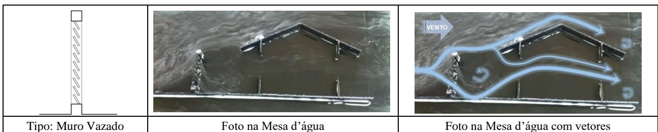
Figura 17 - Ensaio de escoamento, modelo com muro vazado, direção para baixo, inclinação de 60° e recuo de 3 m.
