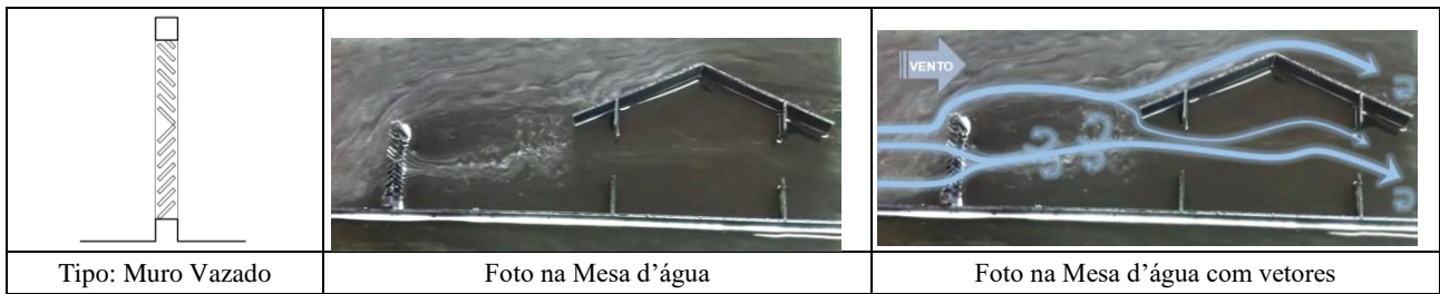
Figura 13 - Ensaio de escoamento, modelo com muro vazado, direção combinado 1, inclinação de 45° e recuo de 5 m.
