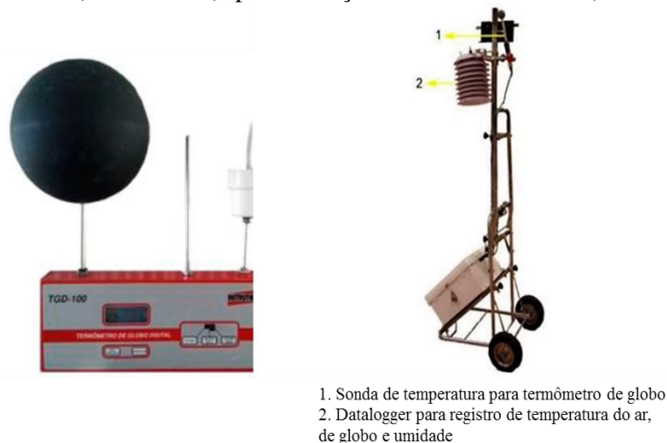
Figura 4. Termômetro de Globo digital Instrutherm TDG-100 e Estação meteorológica móvel com datalogger
