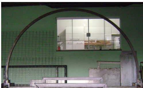
Figura 6 – Arco maior produzido na máquina calandra.
