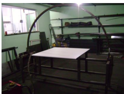
Figura 12 – Tampo/mesa removível posicionado sob a estrutura do heliodon.
