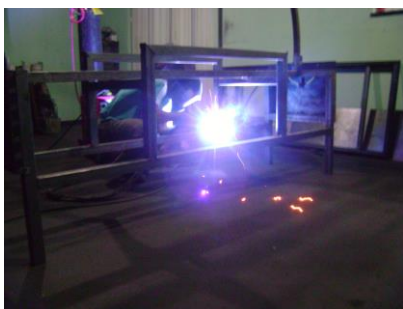
Figura 10 – Soldagem da estrutura do heliodon.
