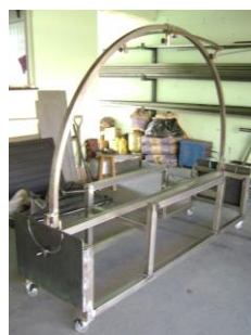
Figura 11 – Heliodon com sua estrutura finalizada
