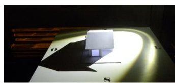
Figura 23 – Simulação para o solstício de verão, às 9h, no heliodon desenvolvido.
