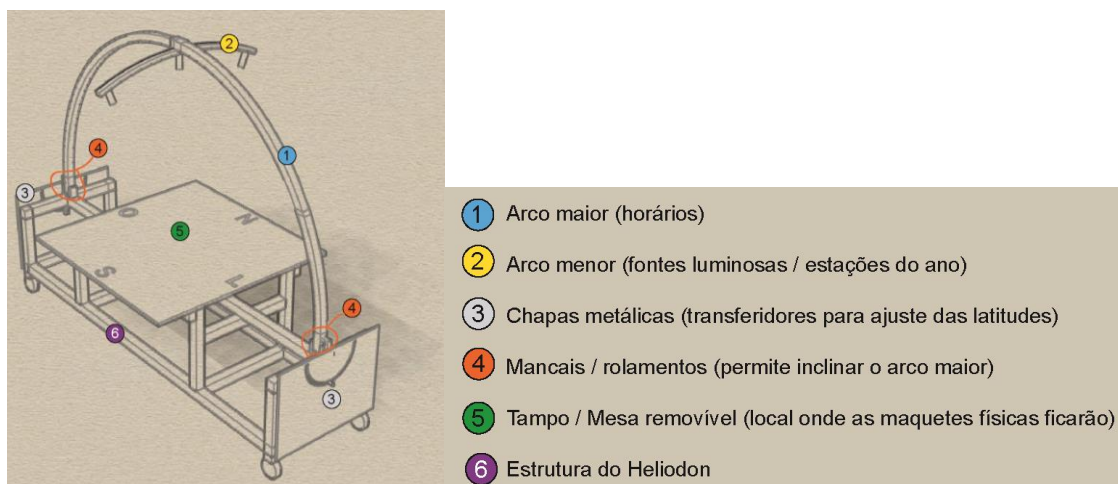
Figura 4 – Perspectiva ilustrativa do heliodon alternativo.
