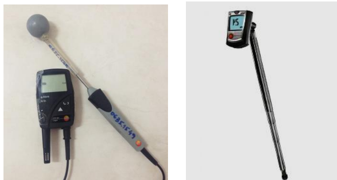
Figura 3–a. Data logger Testo 177-H1 com sensor externo com globo plástico cinza ; b. Anemômetro Testo 405.
