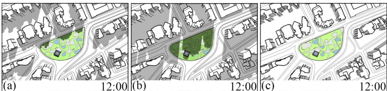
Figura 2: Sombreamento na praça nos equinócios (a), solstícios de inverno (b) e solstício de verão (c), ao meio dia
