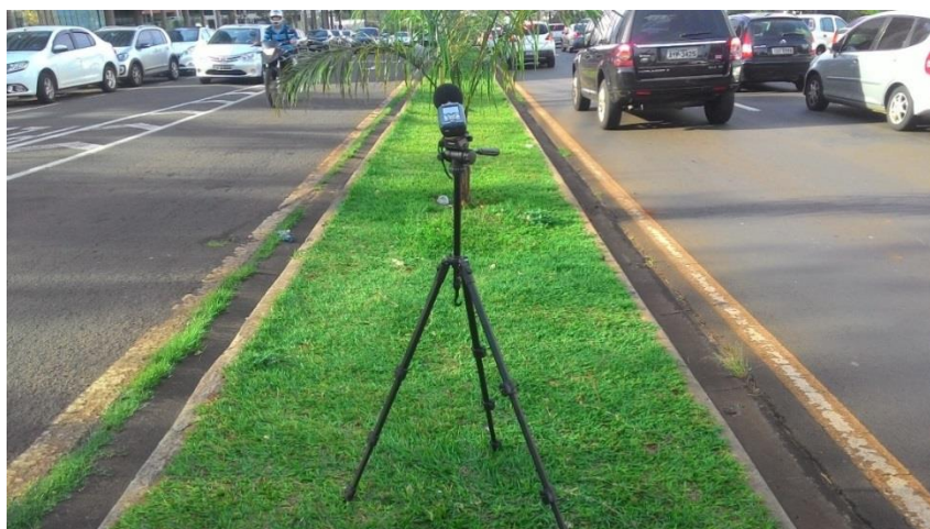
Figura 4b – Medidor posicionado no canteiro central da via durante a realização das medições.
