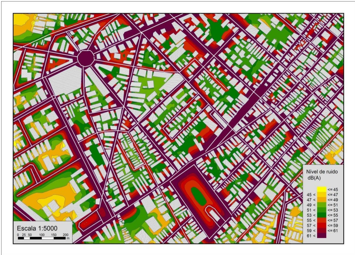
Figura 3 Simulação da distribuição da energia sonora na região central da cidade de Taubaté (SP) com a condição do pavimento desgastado.
