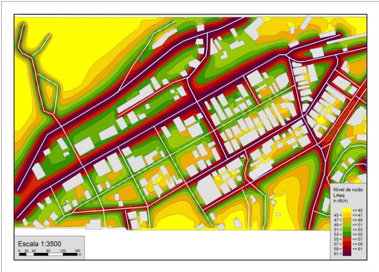
Figura 5 Simulação da distribuição da energia sonora na região central da cidade de Campos do Jordão (SP) com a condição do pavimento desgastado
