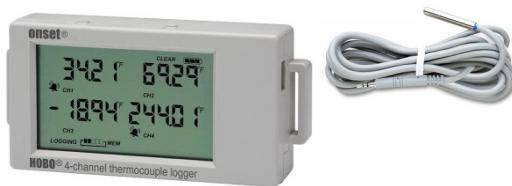
Figura 3 – Imagem do Equipamento de aquisição de dados de temperatura, modelo U12-008 com sensor modelo TMC50-HD. Fonte: www.onsetbrasil.com.br
