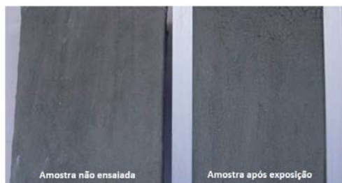
Figura 22 – CP4 após 400 horas no equipamento
