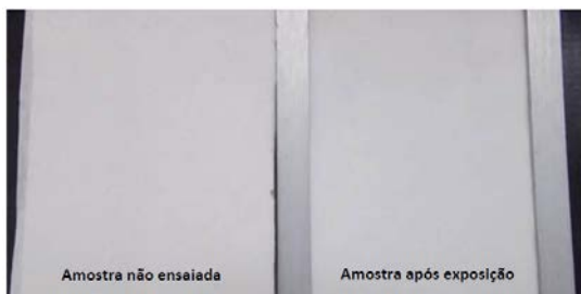
Figura 18 – CP3 após 200 horas no equipamento
