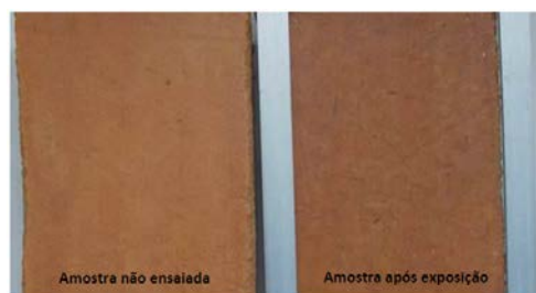
Figura 16 – CP2 após 400 horas no equipamento
