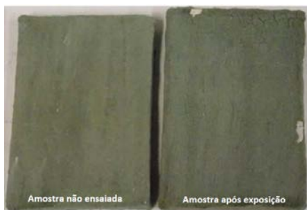
Figura 23 – CP4 após 600 horas no equipamento
