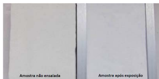
Figura 13 – CP1 após 400 horas no equipamento
