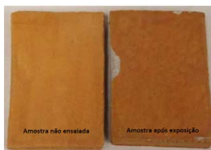
Figura 17 – CP2 após 600 horas no equipamento
