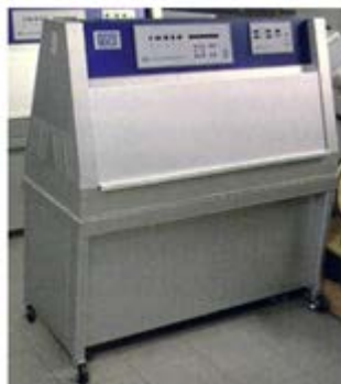
Figura 11 – Equipamento de envelhecimento acelerado QUV/se
