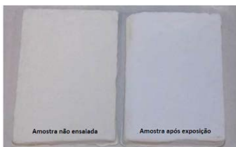
Figura 14 – CP1 após 600 horas no equipamento
