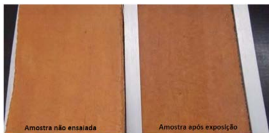
Figura 15 – CP2 após 200 horas no equipamento
