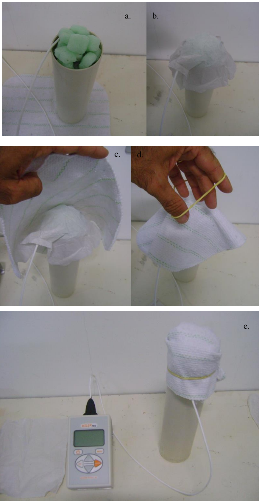
Figura 8 – (g) Tubo de PVC com flocos de poliestireno para isolamento térmica do conjunto corpo de prova e sonda; (h) papel sobre tubo; (i) tecido de algodão sobre tubo; (j) amarração da isolamento térmica ao tubo de PVC; (k) corpo de prova, sonda e equipamento prontos para início das medições
