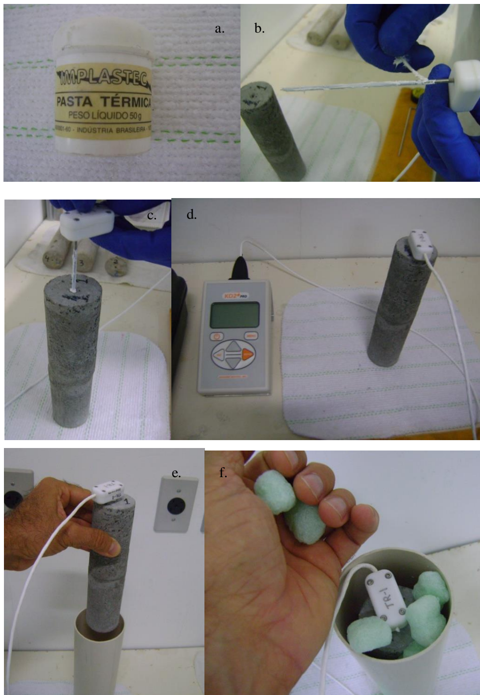
Figura 7 – (a) Pasta térmica; (b) recobrimento da sonda TR-1 com pasta térmica; (c) inserção da sonda no corpo de prova; (d) conjunto corpo de prova, sonda e equipamento de medição; (e) montagem do conjunto corpo de prova e sonda em tubo de PVC; (f) colocação de flocos de poliestireno para isolamento térmico do conjunto corpo de prova e sonda.
