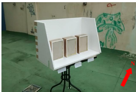
Figura 6: Anteparo de poliestireno ao redor dos modelos.
