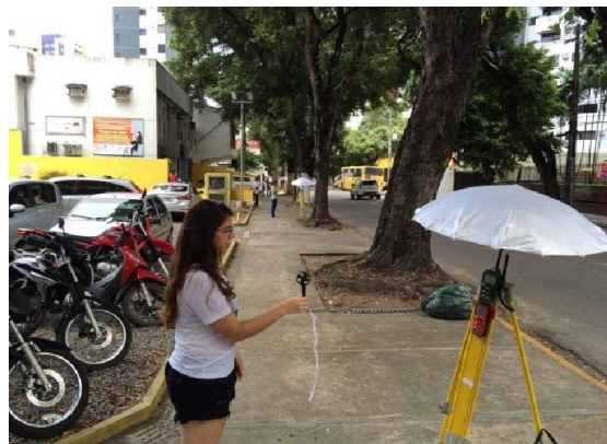
Figura 2 – Tripé com os instrumentos de medição, protegidos com o guarda-sol. Fonte: Wilson Barboza, 2015.
