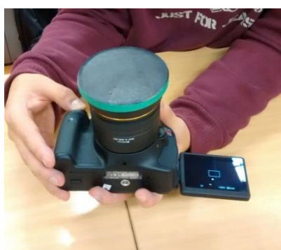
Figura 4 – (a) Tampa com três furos necessários para calibração colocada sobre a lente; (b) Série de imagens registradas em diferentes rotações da lente grande angular.
