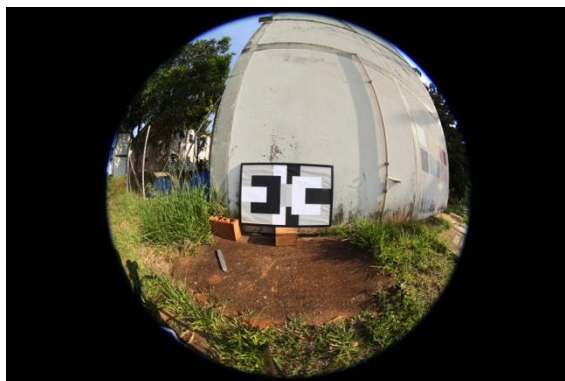
Figura 1 – Registro do campo de visão a partir de uma objetiva olho de peixe, mostrando o painel de calibração e as áreas ao redor.
