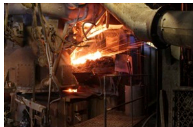
Figura 4 – Saída da rocha fundida, sobre os rolos centrfugos.
