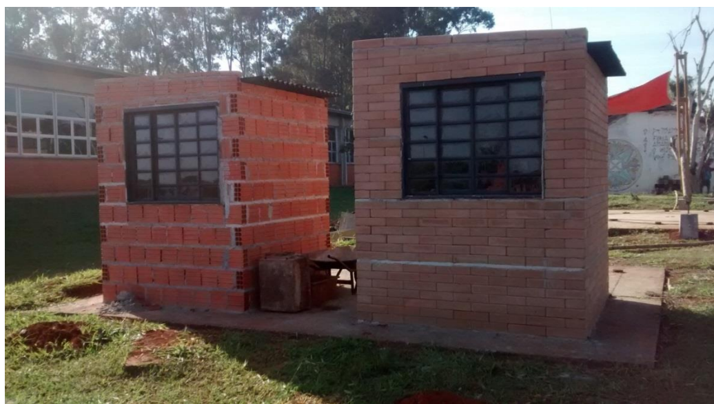
Figura 4 – Células-teste de bloco cerâmico e de tijolo de solo-cimento.
