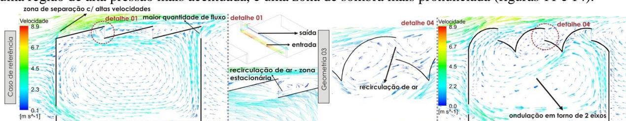
Figura 14 - Vetores de velocidade do ar para o CR e G03 - ângulo de 0°.
