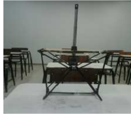
Figura 8 – Aparelho TESTO 405-V e suporte.
