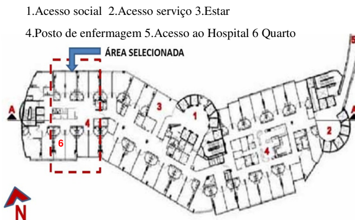
Figura 2 – Planta baixa do pavimento de internação/ Hospital-dia.
