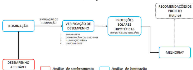
Figura 7 – Fluxograma do processo de simulação de iluminação natural.
