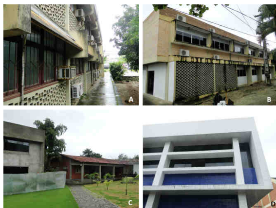
Figura 2 – Exemplos de proteções solares: A) Inclinação; B) Horizontal/Vertical; C) Alpendre; D) Prateleira de Luz.
