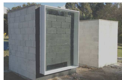
Figura 3 - Células teste construídas por Kruger (et al 2013)
