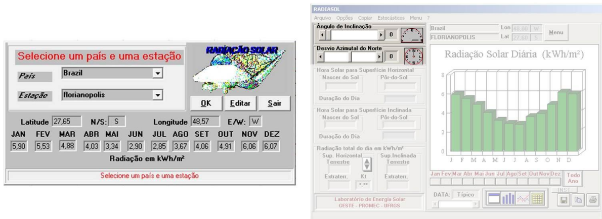
Figura 6 - Interface inicial do aplicativo Radiasol (entrada de dados) e interface do aplicativo Radiasol (definição da inclinação e desvio azimutal).
