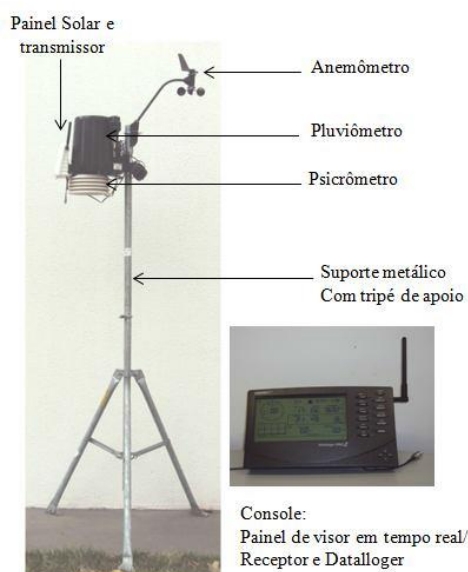
Figura 2 – Estação micrometeorológica automática Vantage Pro 2 Plus
