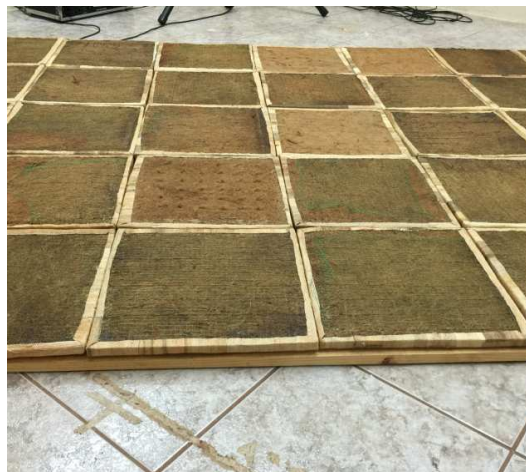
Figura 12 – Configuração PBIP : Protótipo fabricado em lamina feita em palha bananeira fixada em lamina de algodão e prensada em placa de fibra de coco com 25 mm. Essa situação foi montada com módulos invertidos com área de fibra de coco na parte superior montada sobre caibros existindo um plenum de 25 mm
