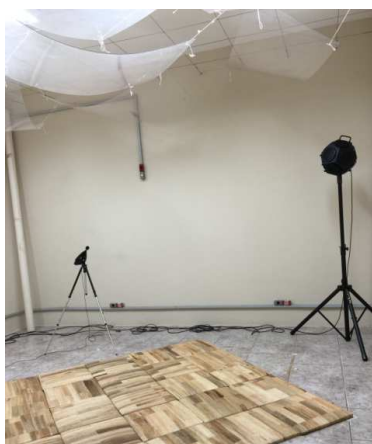
Figura 9 – Configuração PB Protótipo fabricado em lamina feita em palha bananeira fixada em lamina de algodão e prensada em placa de fibra de coco com 25 mm. Essa situação foi montada diretamente no chão
