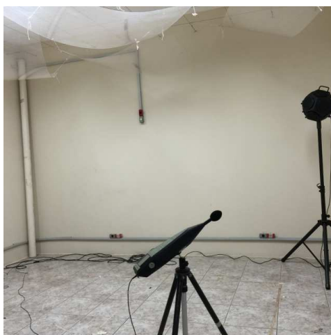
Figura 13 - Configuração CRV : Câmara reverberante vazia
