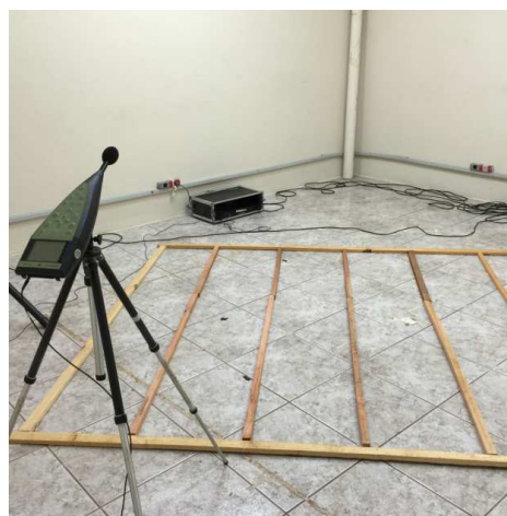
Figura 14 – Engradado dos caibros onde seriam montadas as amostras.
