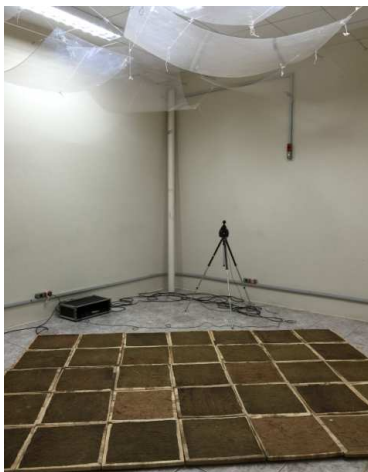
Figura 11 – Configuração PBIP : Protótipo fabricado em lamina feita em palha bananeira fixada em lamina de algodão e prensada em placa de fibra de coco com 25 mm. Essa situação foi montada com módulos invertidos com área de fibra de coco na parte superior montada sobre caibros existindo um plenum de 25 mm
