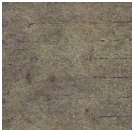
Figura 6 – Fibra de coco natural prensada com tratamento especial de retardante ao fogo.
