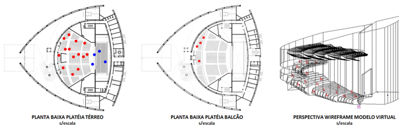
Figura 2 – Plantas e modelagem computacional com disposições de fontes e receptores sonoros. Fonte: os autores a partir de PREFEITURA MUNICIPAL DE CAMPINAS, 2015.
